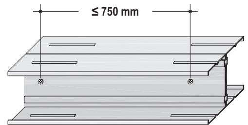
Knauf CW-Profile mit Blechschraube LB 3,5x9,5 mm im Abstand von  $\leq 750 \text{ mm}$  im Steg verschrauben
